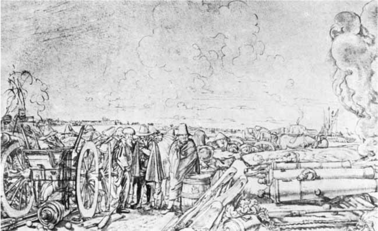
Een vroeg 17de-eeuwse afbeelding van het beproeven van bronzen kanonnen even buiten Rotterdam. Men lette op het kennelijk uit elkaar gesprongen stuk geschut op de voorgrond. (Naar: R.Roth, The Visser Collection , Vol. II, Zwolle, 1996)
